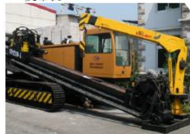
Horizontal directional drilling 水平定向钻机
